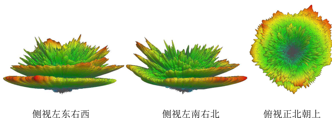
图 6-2 本项目 2#中波塔频率 2 电磁环境仿真计算三维方向性示意图
